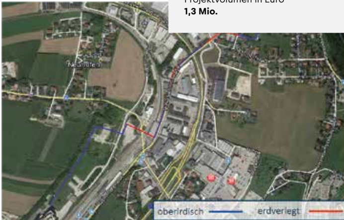
Verlauf der Abwärmeleitung am Satellitenbild.
