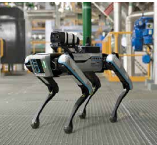
Vierbeiniger Roboter für effizientere Inspektionsprozesse.
