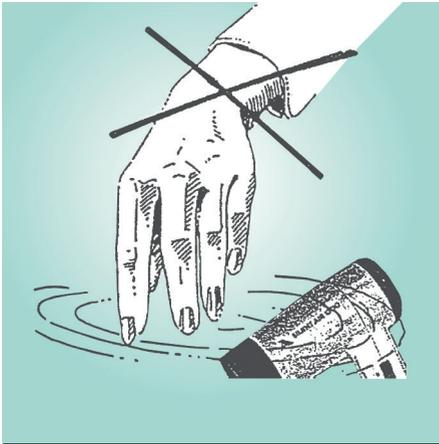
Bei Unfällen im Zusammenhang mit Wasser (z.B. Badewanne, Duschecke, Schwimmbecken) ist darauf zu achten, dass erst nach Abschalten des Stromkreises ins Wasser gegriffen werden darf.
