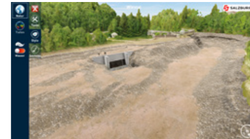
Thomas Nemetz' Innovation: Ein System aus Hard- und Software, das Unterwassergelände scannt und aus den so gewonnenen Daten dreidimensionale Untersee-Karten von Wasserkraftwerken generiert.
